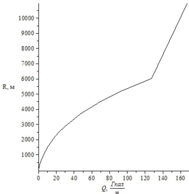
Рисунок 2.1 График радиуса теплоснабжения для канальной прокладки
