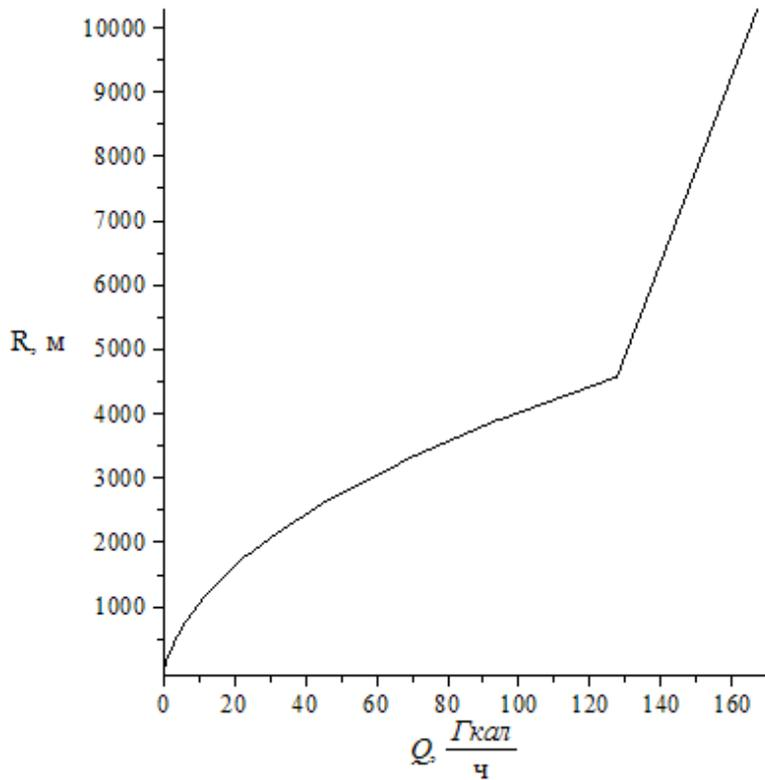
Рисунок 2.2 График радиуса теплоснабжения для бесканальной прокладки
